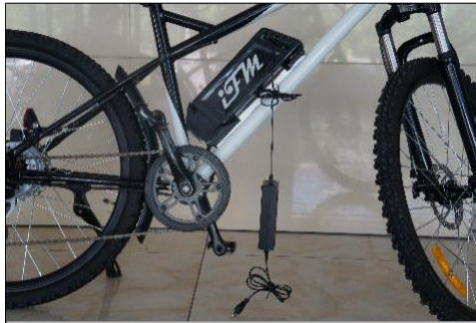
Figura 12 - Cavodella carica batterie collegato alla batteria d'alimentazione della bicicletta.
